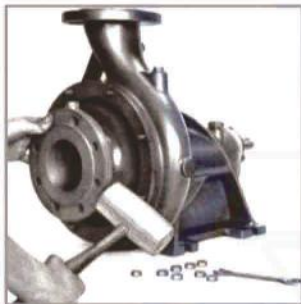
شکل ۹: جدا کردن فلنج مکش
