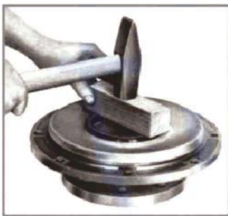
شکل ۱۶: جا زدن رینگ سایشی
