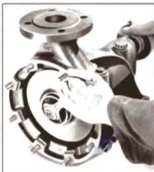
شکل ۱۰: باز کردن مهره شش گوش پروانه
